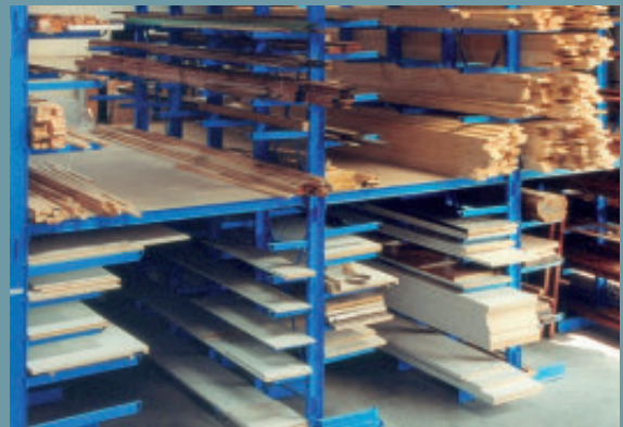
Kragarmregal-Lagerbühne: Ausführung als Zwischengeschoss. Unten Lagerung von Holzplatten, oben Lagerung von Kantholz. Manuelle Bedienung im direkten Zugriff.
