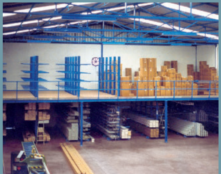
Lagerbühne als Zwischengeschoss mit Kragarmregalen. Oben Paketlagerung und teilweise Regalierung.
