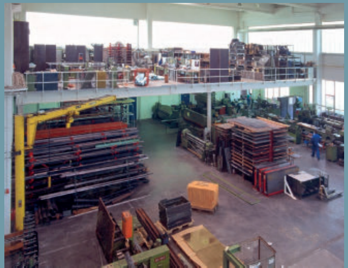
Doppelte Fläche in der Stahlbearbeitung. Oben und unten Arbeitsplätze. Belastung von 1.000 kg/qm.
